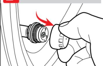
**3** 取下舊電池片,換上新的扭扣式電池。(注意電池正負極)
