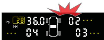
5. 收到偵測器配對信號後，將顯示當前輪胎氣壓值和溫度。
