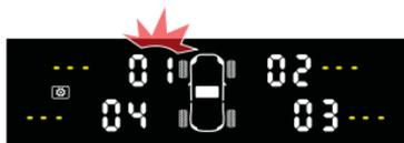
3. 將偵測器安裝好，接收信號成功，顯示當前輪胎氣壓及溫度。
