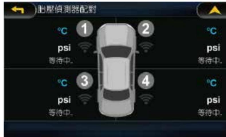
假設1號偵測器遺失，換新的1號偵測器，進入後配對模式，畫面會顯示等待中，這時請將要配對的胎壓偵測器旋入輪胎氣嘴，查看是否有顯示胎壓資訊。
