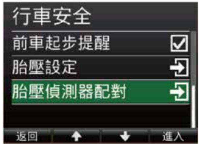
假設4號偵測器遺失，換新的4號偵測器，進入後配對模式，畫面會顯示配對中，這時請將要配對的胎壓偵測器旋入輪胎氣嘴，查看是否有顯示藍色的胎壓資訊。
