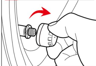
**4** 用螺母扳手反方向鎖緊偵測器
